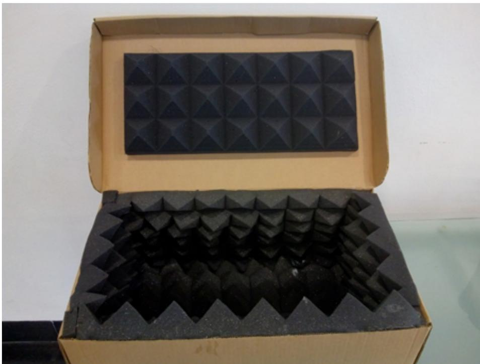
Figura 19. Caja acústica construida utilizando una caja de cartón y recubierta en sus paredes, base y tapa internas con espuma acústica de forma piramidal.
