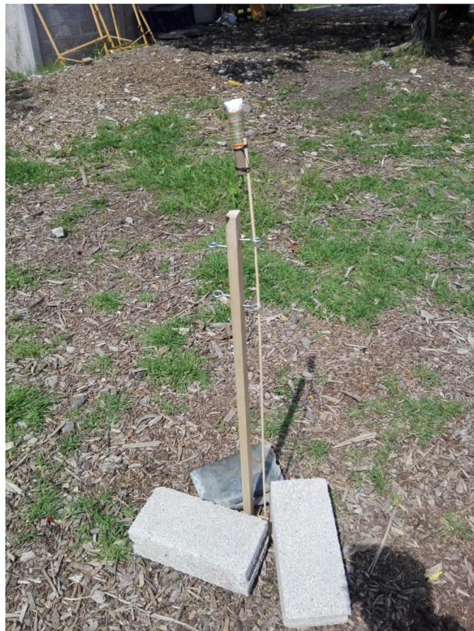
Figura 37. Fotografía de la colocación del cohete en el soporte de madera.
